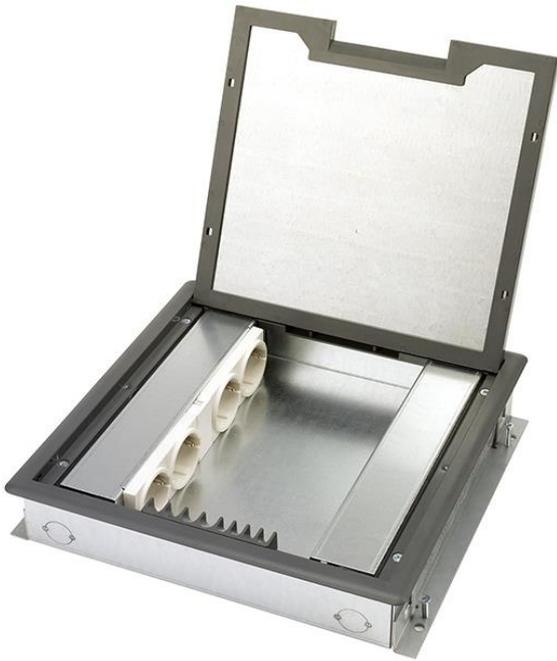
Entre las características de la caja de suelo VELOX® 2.0 destaca una altura de montaje de 50 milímetros, ideal para proyectos de renovación. Las bandas de fijación, equipadas con cuatro pernos de ajuste, facilitan enormemente el montaje. Además, el paquete incluye una cubierta de recubrimiento temporal (placa MDF).
