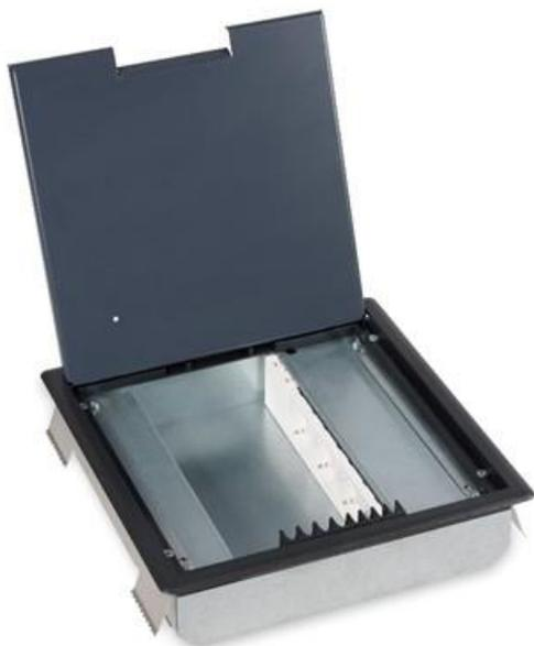
TETRA FUSION de OCS se puede usar en suelos técnicos. TETRA FUSION viene de serie con una cubierta abatible con un bastidor de plástico para moqueta (5-6 mm) o linóleo; también puede optar por una tapa de acero inoxidable apta para una profundidad de inserción de 15 mm en piedra natural o parqué. Tras hacer el recorte en el suelo, puede colocar la caja y apretar cuatro tornillos para fijarla en su sitio.
