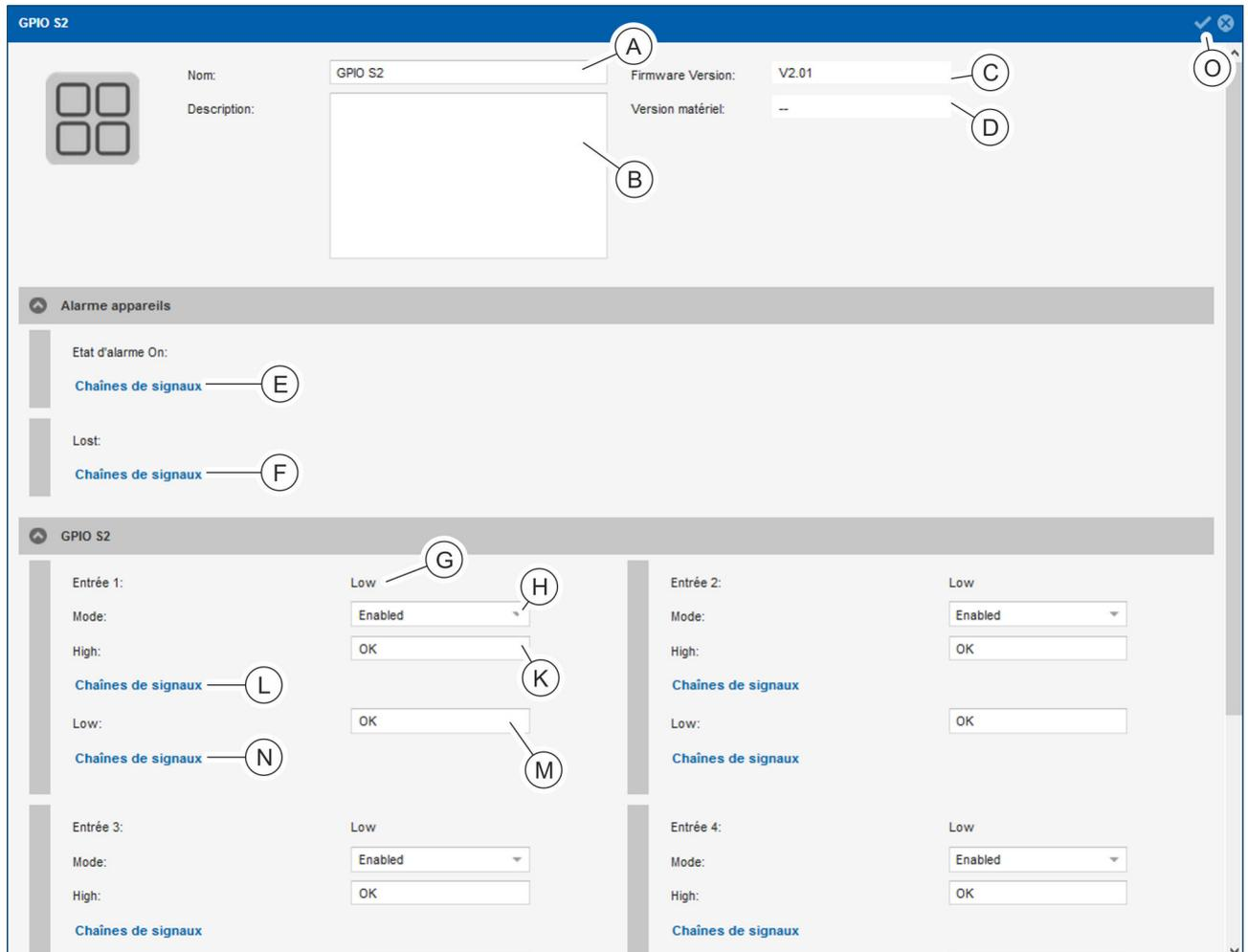
Fig. 116 : Menu « État » – Onglet « Capteurs » (module GPIO dans l'affichage détaillé)
