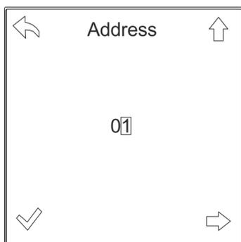
Fig. 73 : Réglage de l'adresse Modbus
