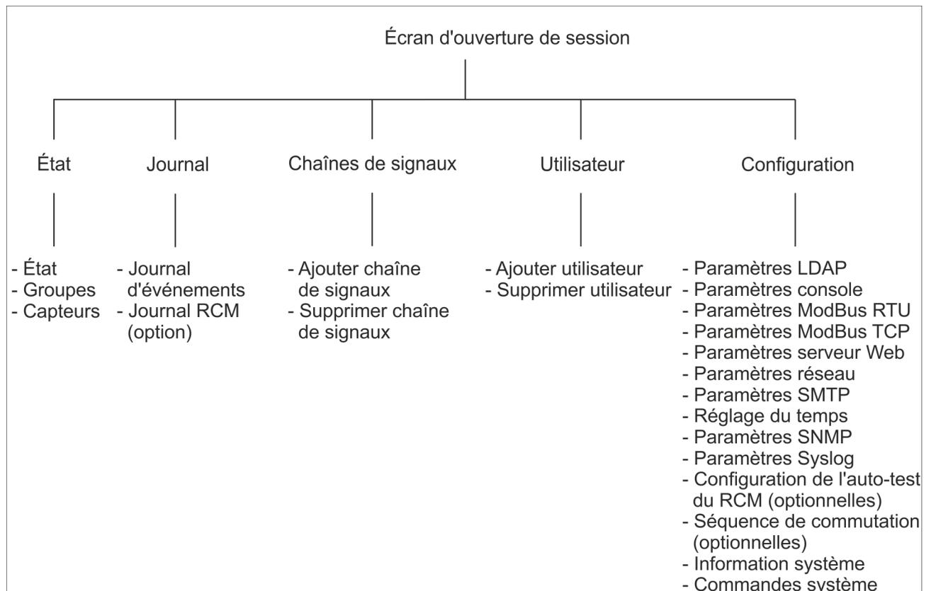
Fig. 86 : Structure des menus de l'interface web
