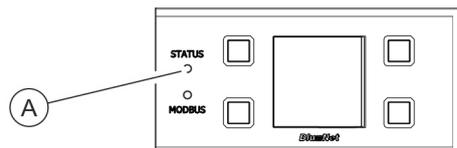
Les DEL d'état (Fig. 10 /Ⓐ) indiquent l'état du PDU ou du PU2. Les états suivants sont possibles :
