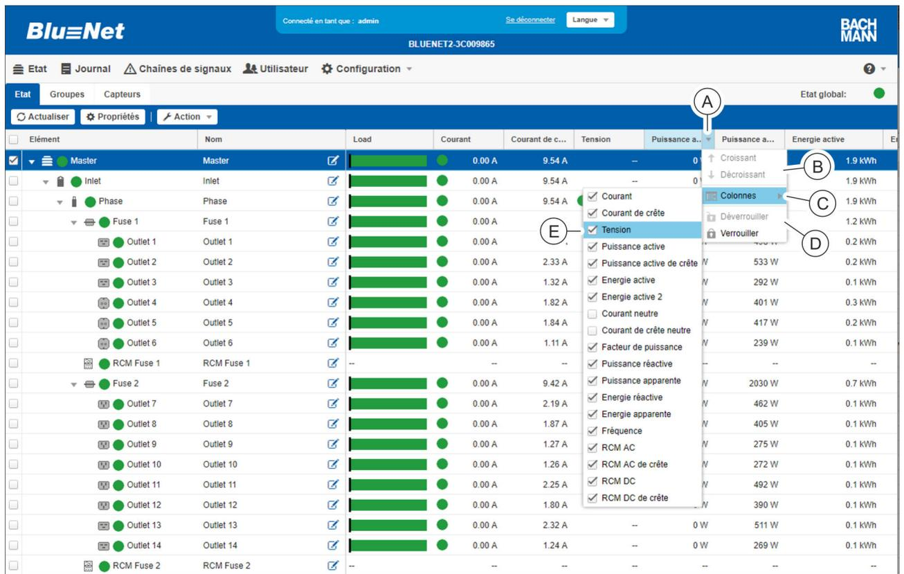
Fig. 94 : Modification du groupement des différentes valeurs mesurées
