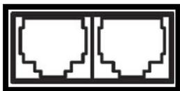
1. Stecker vom BN2000 Sensor in einen der beiden RJ12 Anschlüsse (Abb. 2) am Gerät einstecken.
