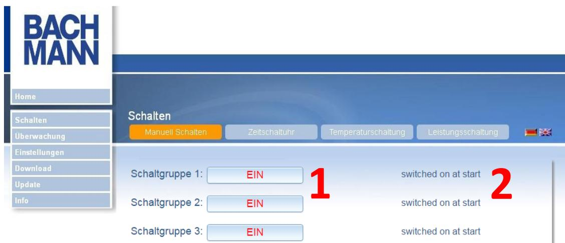
Abbildung 10: Schalten der Steckdosen
