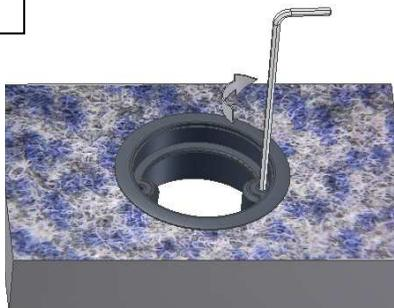
Drehen Sie die inneren Schrauben mit einem Inbusschlüssel M5 eine halbe Umdrehung, bis der Bodenauslass im Boden fixiert ist.
