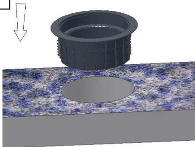
Der Bodenauslass kann von oben in ein rundes Loch eingesteckt werden. Das Bohrloch sollte einen Durchmesser von 112mm haben.
