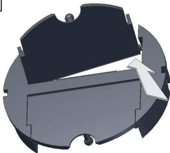
Wenn der Auslass nicht mehr verwendet wird, kann der Deckel geschlossen werden, so dass der Auslass als Blinddeckel verwendet wird. Hebeln Sie den inneren Teil wie unter Pkt. 1 beschrieben und drücken Sie an einer Seite des Deckels (siehe Pfeil), bis dieser austrastet. Anschließend setzen Sie den Deckel wieder bündig zum inneren Teil ein.
