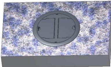
Wenn die Deckel verschlossen sind, kann man den Bodenauslass auch betreten. Die Punktbelastung (18 x 18mm) ermöglicht eine Gewichtsgrenze von 150kg (1500N).
