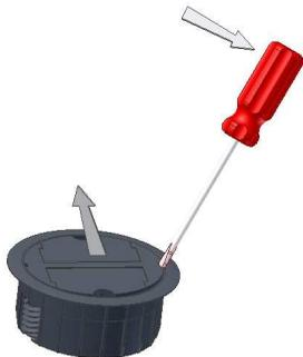
Hebeln Sie den mittleren Teil des Auslasses mit einem Schraubendreher an beiden Seiten des Mittelteils aus (siehe Aussparungen) und ziehen Sie diesen nach oben raus.
