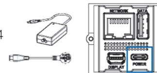
STEP con ej. Cargador 60W + 918.203 cable USB C
